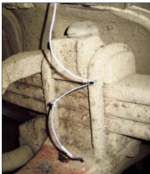
Sensorer på en timmerbils hjul, ram, hytt och förarsäte avslöjade att väg 331 erbjuder lastbilschaufförerna en mycket dålig arbetsmiljö.
