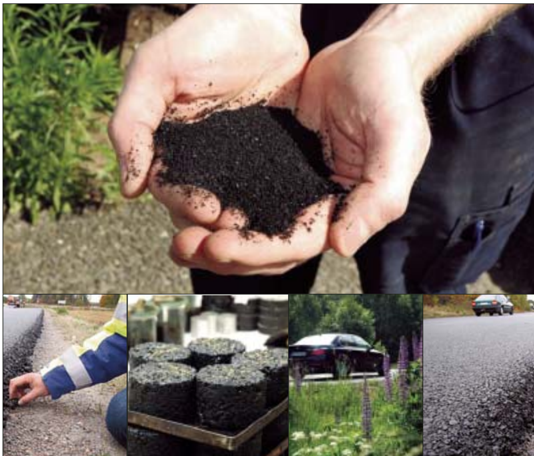
Krossade däck blir gummigranulat. Så kallade "provkoppar" av gummiasfalt används för att studera dess egenskaper.
